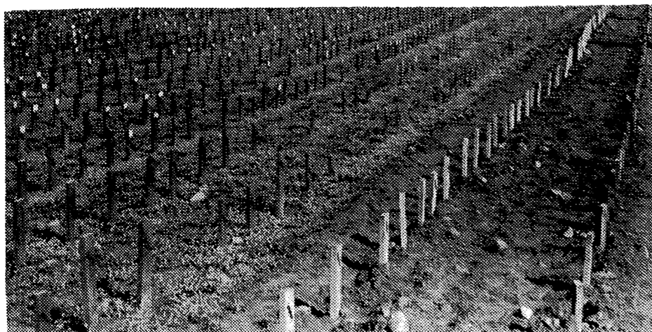
Figur 1. Beständighetsförsök med virke i markkontakt.
